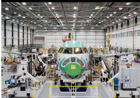
Assemblage d'un avion Global 7000
